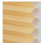
ハニカム（蜂の巣）構造の生地がつくる空気層により、窓辺の断熱性が高まり、冷暖房効率を向上します。また、生地の内部をコードが通るため、穴からの光漏れがないうえ、意匠性にも優れています。
